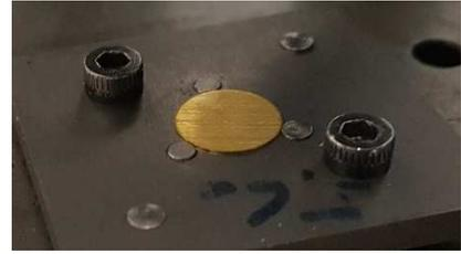
**Il faut descendre le piston fermement mais sans aller trop vite sinon l'emboutissage part de travers.**
