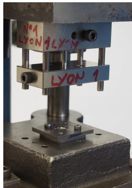
Sous la matrice utilisée, on met une matrice de diamètre plus important pour équilibrer la hauteur de l'assemblage.
